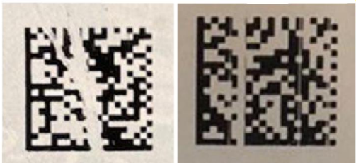
Нарушение целостности КМ*
